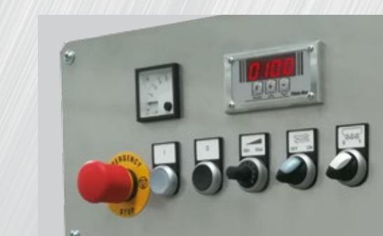
Pannello di controllo con contatore
