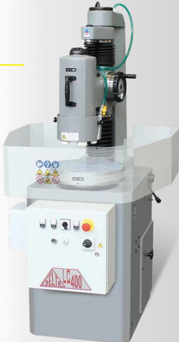
Les caractéristiques techniques communes à toute la gamme sont les mêmes pour ces rectifieuses. Ces modèles présentent tous une structure solide en fonte de la meilleure qualité dotée d'un bras robuste porte-colonne afin de donner à la machine une rigidité maximum (le modèle **LC500** a une structure dimensionnellement agrandie); la puissance du moteur broche est de 3 kW (4HP).
